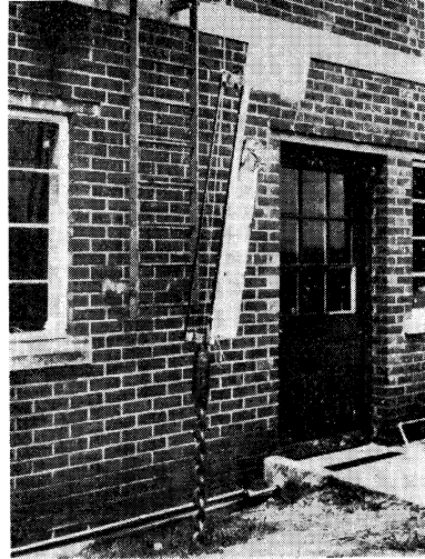
第3図 J. N. CARRUTHERS の流速計—hydro wire のおもりまで下降した状態、実際にはおもりを通過し角型の箱からナイロンロープを繰り出して海底まで落下する。
