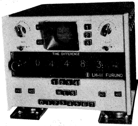
自動測深方式ロラン探知機 (日、英、仏、加 特許)
